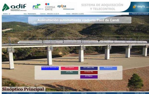
**Figura 32.** - Sinóptico principal de acceso a los diferentes grupos de sensores
