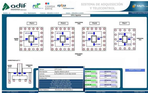
Figura 33. - Sinóptico de acceso a los datos de las CPT en zapatas
