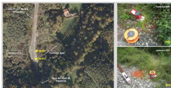
**Figura 17.** - Inclinómetros en terraplén de Zegama. Guipuzcoa
